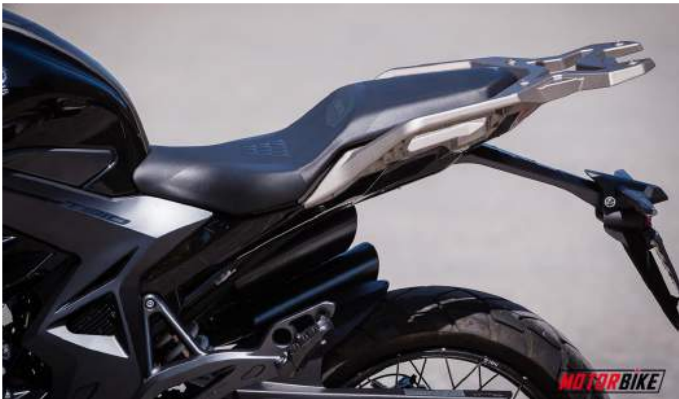
Σέλα δύο επιπέδων και αλουμινένια σχάρα με χειρολαβές
