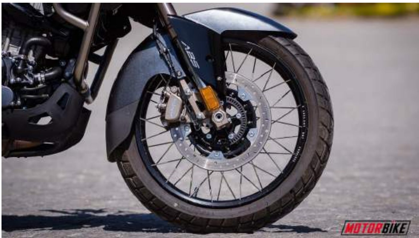
Ανάποδο πιρούνι, τροχός 19 ιντσών με ακτίνες και δισκόφρενο με δαγκάνα δύο εμβόλων
