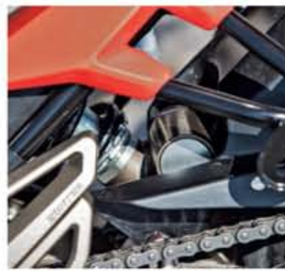
Αλουμινένιο ψαλίδι με ενισχυτικά νεύρα, που θυμίζει αρκετά το αντίστοιχο των KTM
