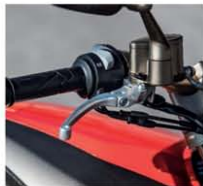
Μανέτες σπαστές και ρυθμιζόμενες, έστω κι αν δεν πρόκειται για τις ακριβότερες του είδους. Παρόλα αυτά μαρτυρούν μια σχεδιαστική προσοχή στη λεπτομέρεια και μια πρόθεση παροχής αναβαθμισμένου εξοπλισμού
