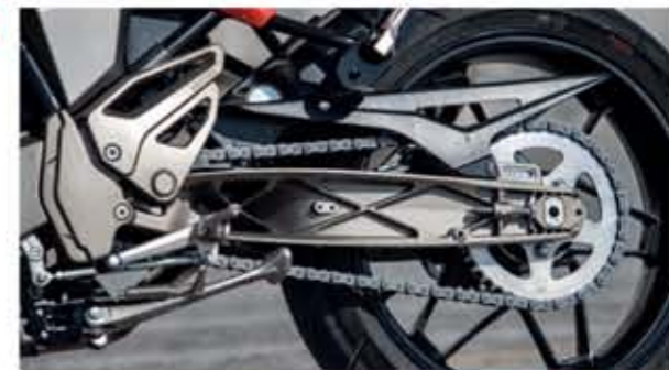
Αλουμινένιο ψαλίδι με ενισχυτικά νεύρα, που θυμίζει αρκετά το αντίστοιχο των KTM
