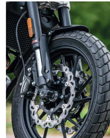
Ο εμπρός τροχός των 18" και το ποιοτικό πηρούνι της KYB με την μεγάλη διαδρομή των 155mm, προσφέρουν κορυφαίο επίπεδο άνεση. Αντίστοιχου επιπέδου και τα φρένα της Nissin για τα δεδομένα της κατηγορίας
